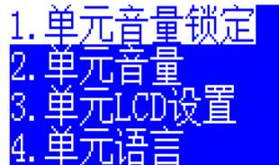
“单元音量锁定”按方向键“上”，锁定或解锁单元耳机或喇叭音量。按方向键“下”，锁定或解锁单元话筒发言音量。按“ESC”键退出，默认保存。
