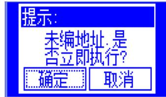
按下“ENTER”键, 进入菜单, 如右图: 同时话筒单元指示灯会闪烁, 逐支按下话筒单元的开关键, 主机会发出“D”一声响同时话筒指示灯熄灭, 表示编辑地址成功, 再按下主机“ENTER”键, 结束编辑地址。
