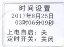
在时间设置页面下，可以校对机器当前的实际年月日时间。这一页面同时也设有“上电自启”和“定时开关”两个选项。定时开关中设有3种状态：关闭、循环、非循环。循环：设定每天固定时间打开；非循环：特定时间打开。上电自启即当机器接通电源，自动启动预设好的通道。
