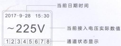
当本机连接上电源后，液晶显示屏上自动显示当前电路中实际电压，数值会随着电压的波动而发生变化。
