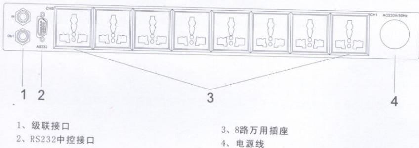
注：通过级联接口连接多台机器时，超过2台建议最后一台机器级联输出接口需要反送第一台主机，在级联模式下，所有从机需关闭自动启动功能。
