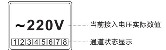
当本机连接上电源后，液晶显示屏上自动显示当前电路中实际电压，数值会随着电压的波动而发生变化。屏幕下方显示当前通道状态，红色显示为接通，绿色显示为没接通。
